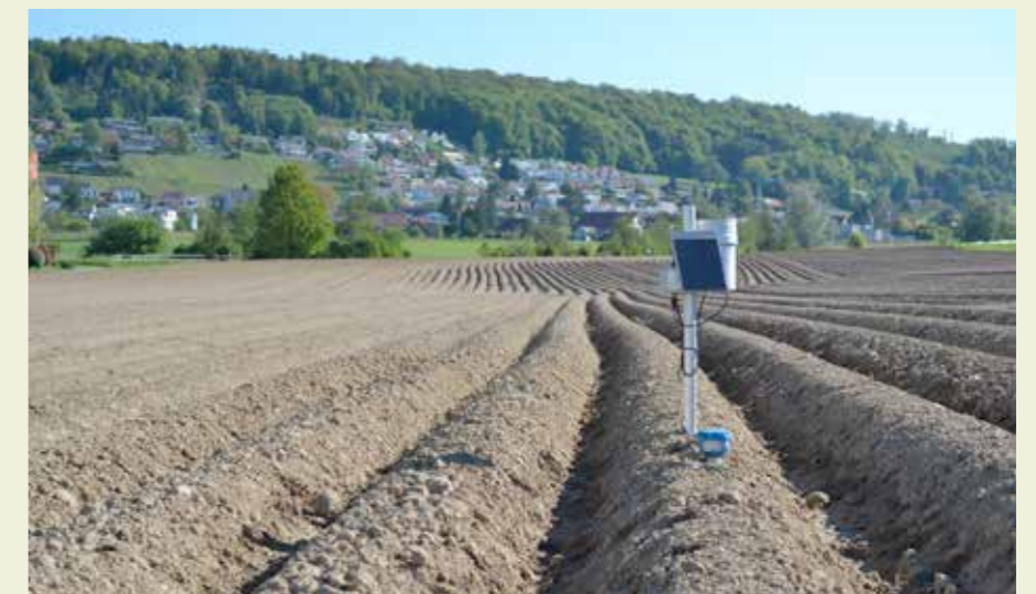
Bodensonden helfen die Bewässerung der Kartoffeln zu optimieren.
