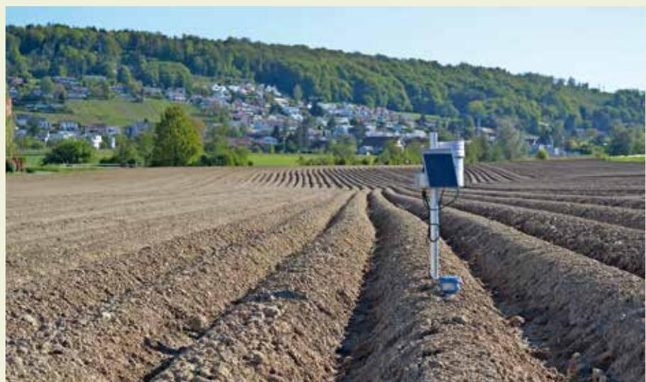
Le sonde sotterranee permettono di ottimizzare l'irrigazione delle patate.
