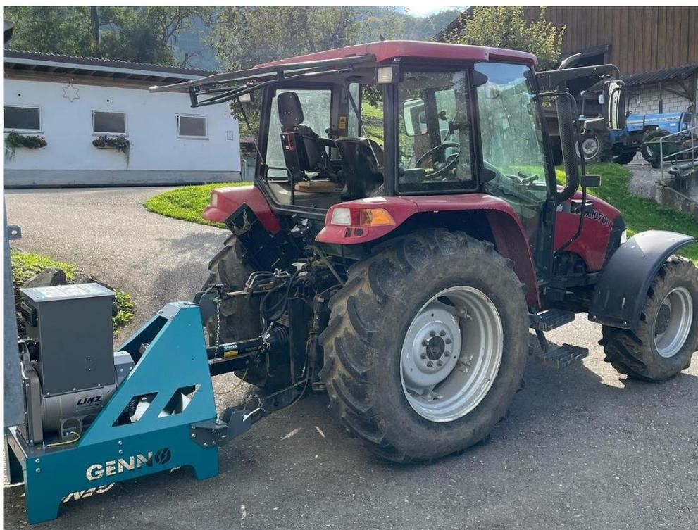
Figure 2: Maschinenring Schweiz "Génératrice entraînée par tracteur"
